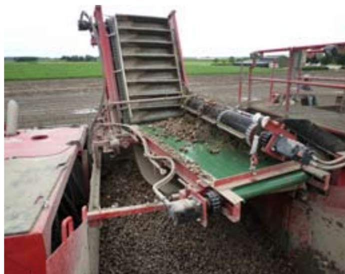
Door middel van de vulband komen de bollen in de bunker
