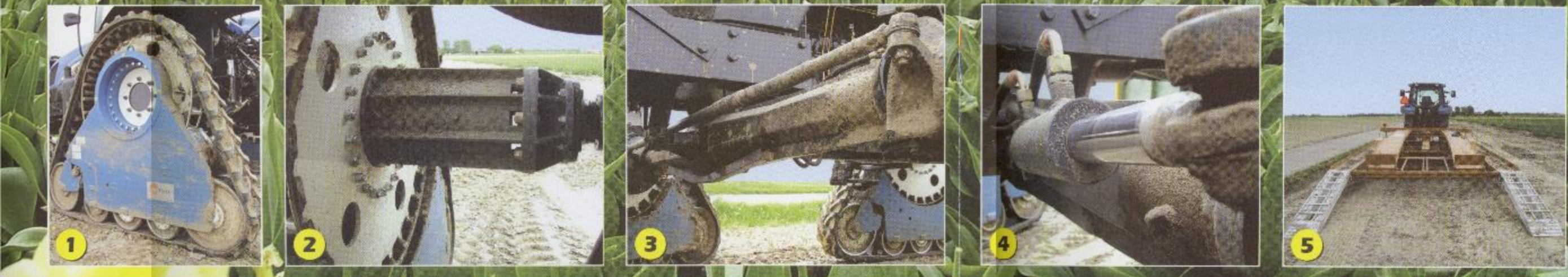
1 Spoorbreedte: 3,05 m 2 Breedte rupsen: 24 cm 3 Vrije hoogte: 70 cm
