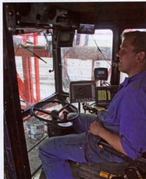
De chauffeur hoeft niet te sturen, dankzij RTK-gps. Hij heeft dus alle tijd de diverse monitoren in de gaten te houden. Dit moet de tweede man op de machine overbodig maken.
